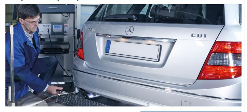
Die Abgasuntersuchung ist ein wichtiger Beitrag zum Umweltschutz und zur Reduzierung der Schadstoffbelastung in unserer Luft. Deswegen wird die AU alle zwei Jahre im Rahmen der Hauptuntersuchung durchgeführt. Seit 2006 heißt die AU offiziell übrigens UMA: Untersuchung des Motormanagement-/Abgasreinigungssystems.
