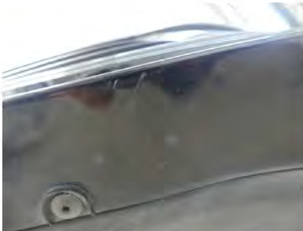
Bild 7 Frontspoiler unten verkratzt Stoßfänger vorn verkratzt
